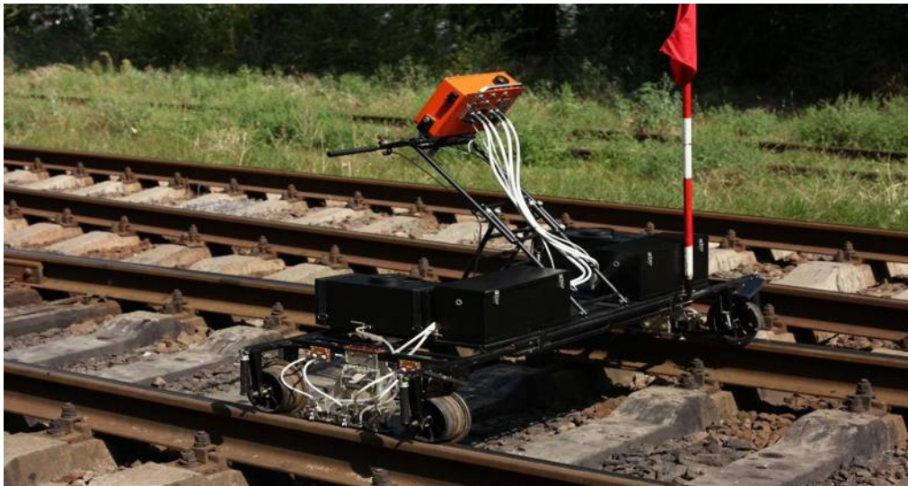
Рисунок 1 - Ультразвуковые дефектоскопы с GPS-привязкой
